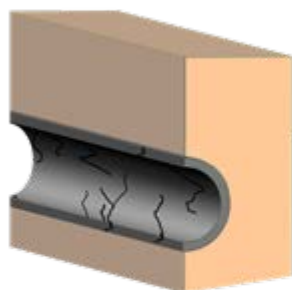
管きよ改築前
