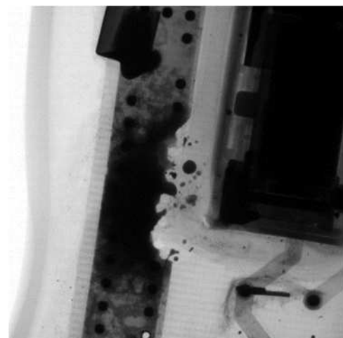
焼損した電化製品の内部（X線透過）
